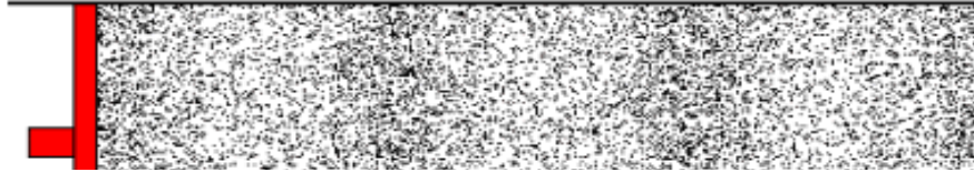
Acoustic Longitudinal Wave
